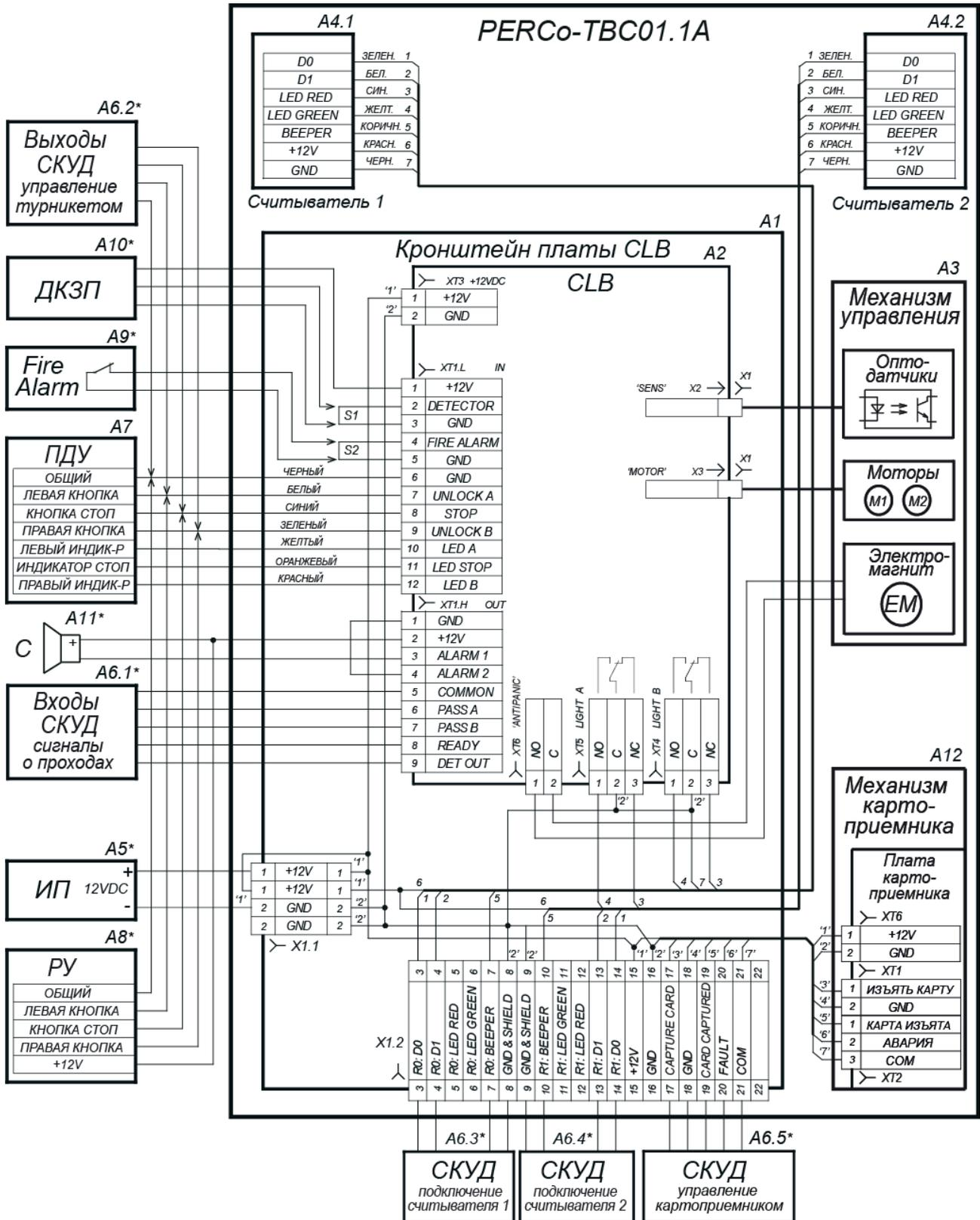
Рисунок 12. Схема электрических соединений турникета<sup>1</sup>
