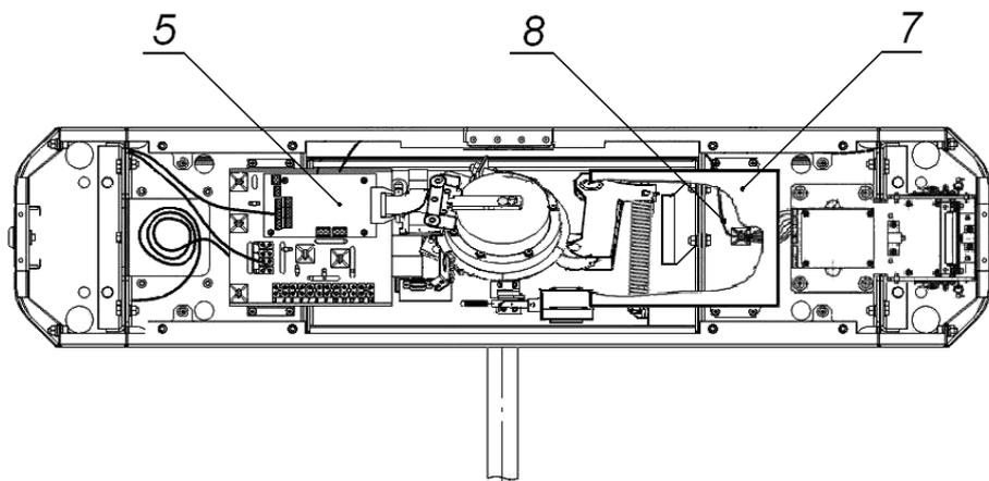
**Рисунок 13. Схема прокладки кабелей в стойке турникета**
