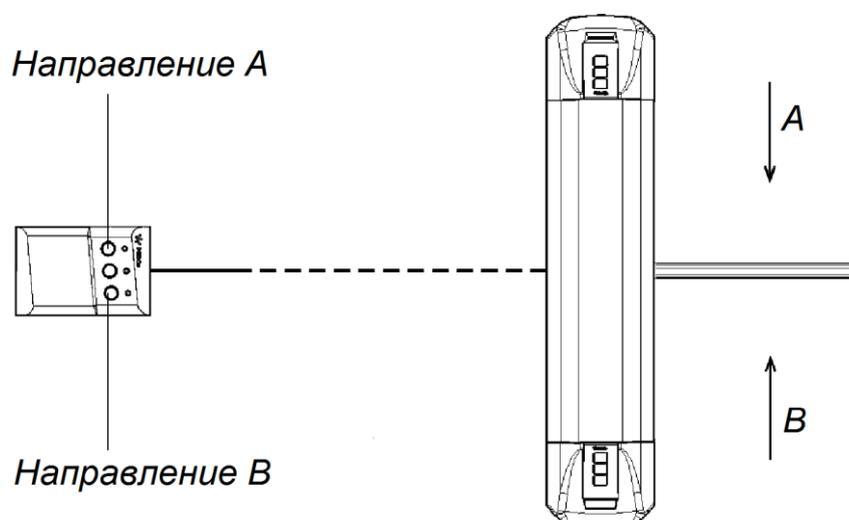
**Рисунок 8. Стандартная ориентация ПДУ относительно стойки турникета**
