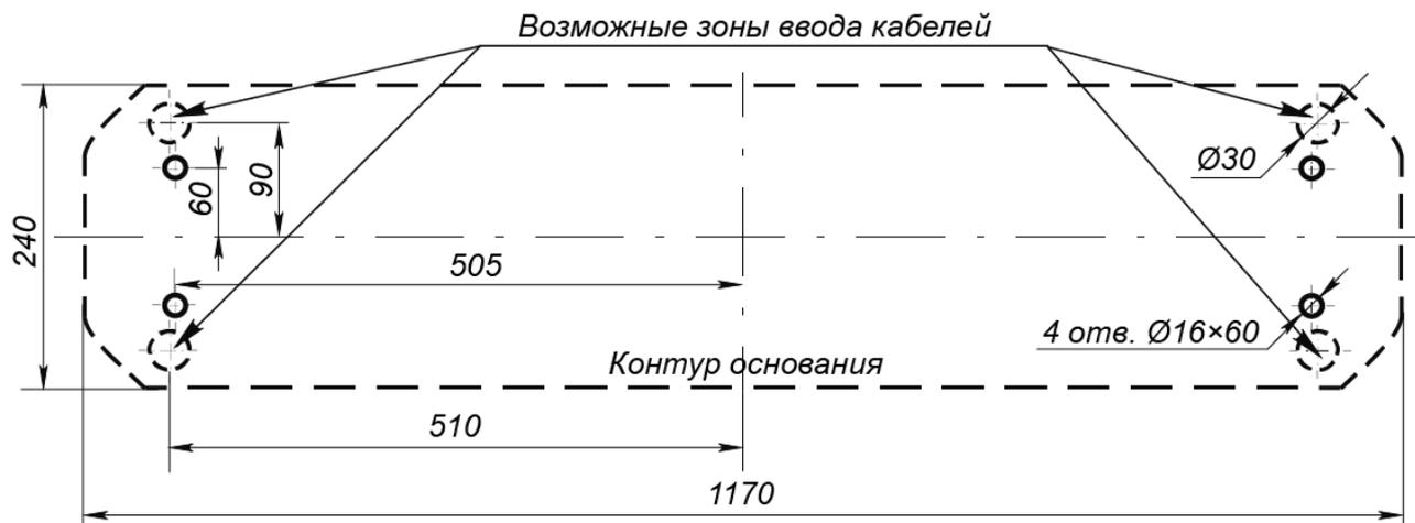
**Рисунок 14. Схема разметки для установки стойки турникета**
